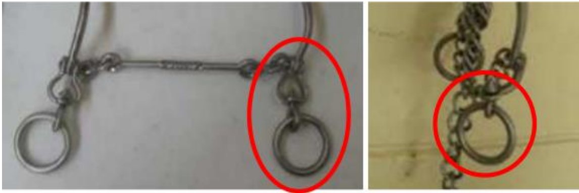
Ilustración: Argollas Flexibles que giran en cualquier dirección (Aceptadas)
